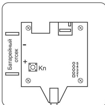
Рисунок 2. Внешний вид платы радиоадаптера сопряжения MP-413D1
